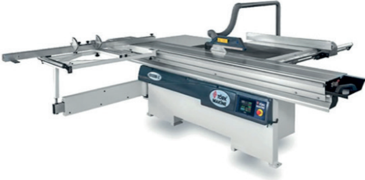
Şekil 1. Çizicili Yatar Daire Testere (URL-1,2023).
