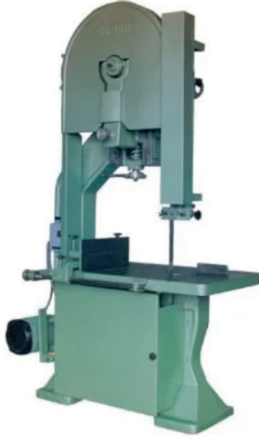
Şekil 3. Şerit Testere (URL-3,2023).
