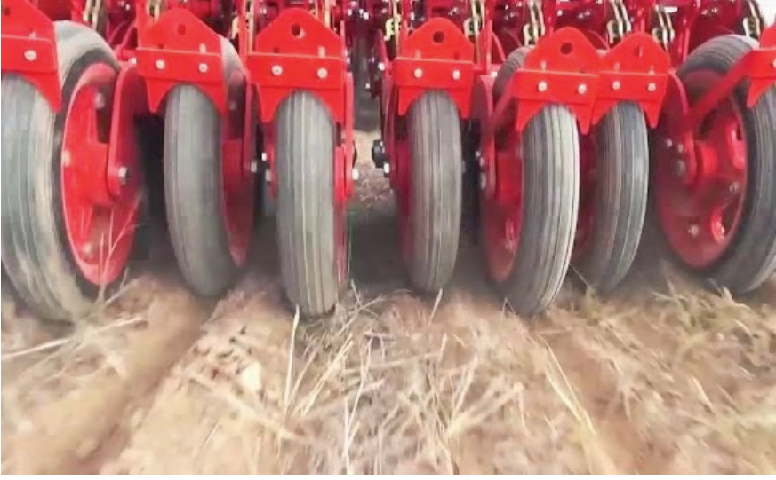
Şekil 8. Anıza ekim makinasının baskı tekerlekleri
