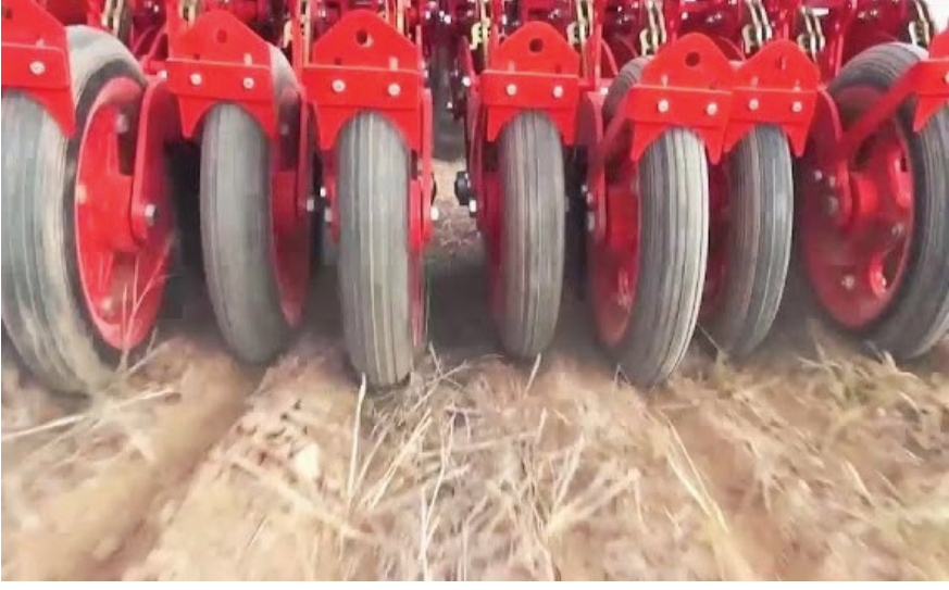
Şekil 8. Anıza ekim makinasının baskı tekerlekleri
