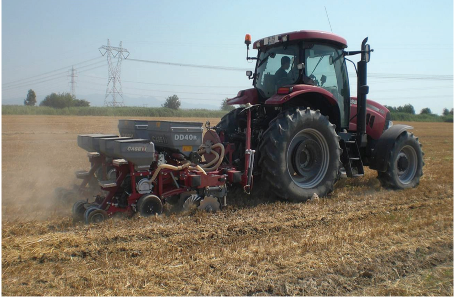
Şekil 1. Anıza ekim yapabilen havalı mibzerin mısır ekiminde tarlada çalışması
