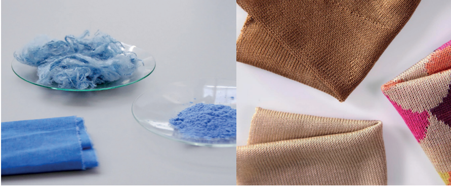
Şekil 14. Ioncell teknolojisi ile üretilmiş elyaf ve kumaş örnekleri (URL-13)
