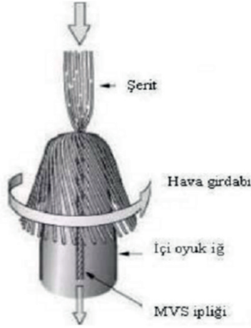
Şekil 1. Murata vortex sisteminde iplik oluşumu (Örtlek ve Ülkü 2008)
