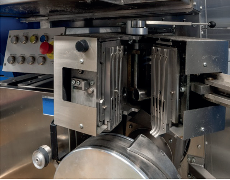
Şekil 8. BCF makinesi yığma kutusu ve soğutma tamburu (vandewiele.com)
