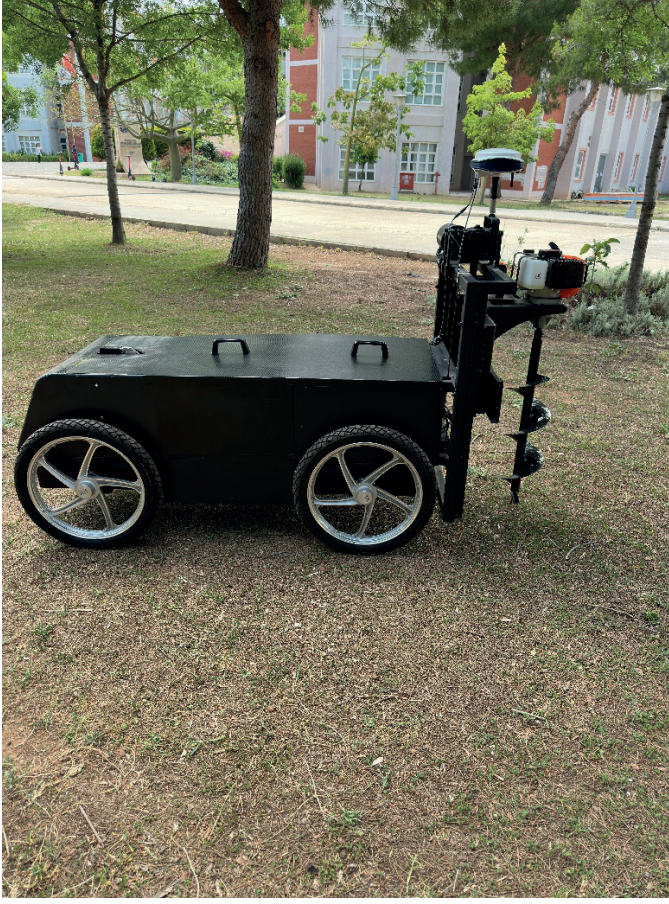
Şekil 1: Otonom burgu robotu (Eceoglu & Ünal, 2024)
