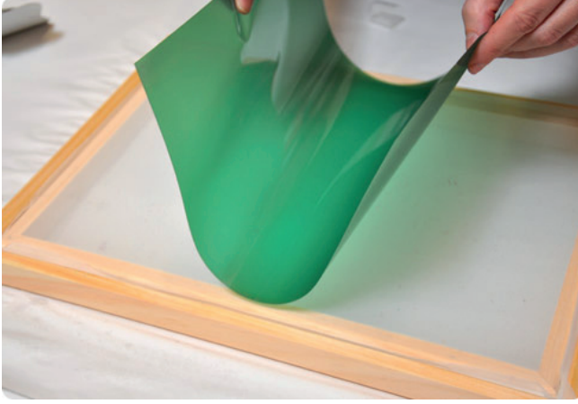
Şekil 4. Kılcal film emülsiyon ( www.dharmatrading.com )
