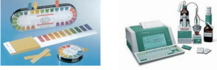
Şekil 11. pH kağıtları ve kolorimetre
