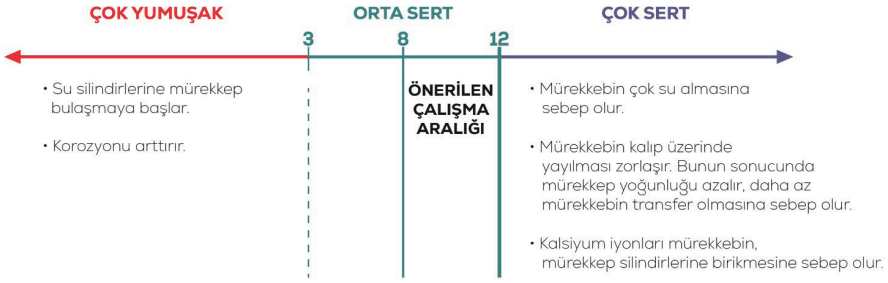
Şekil 8. Nemlendirme suyunun sertlik derecesinin baskı kalitesine etkileri (Mengüberti, 2007).
