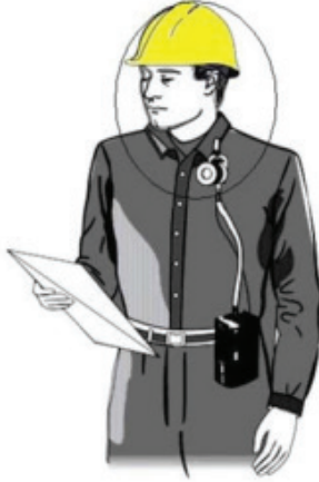
Şekil 3: Gravimetrik Yöntemin Şematik Gösterimi (Ak; Gürpınar, 2019)
