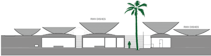
Şekil 3. Yağmur suyu biriktiren iç bükey çatılar (Merdim, 2017).
