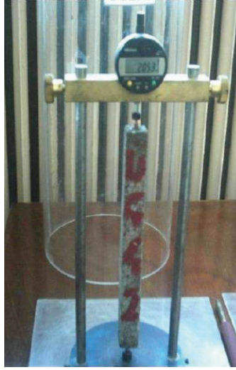
Şekil 10. ASTM C227 Standardına göre boy ölçüm düzeneği
