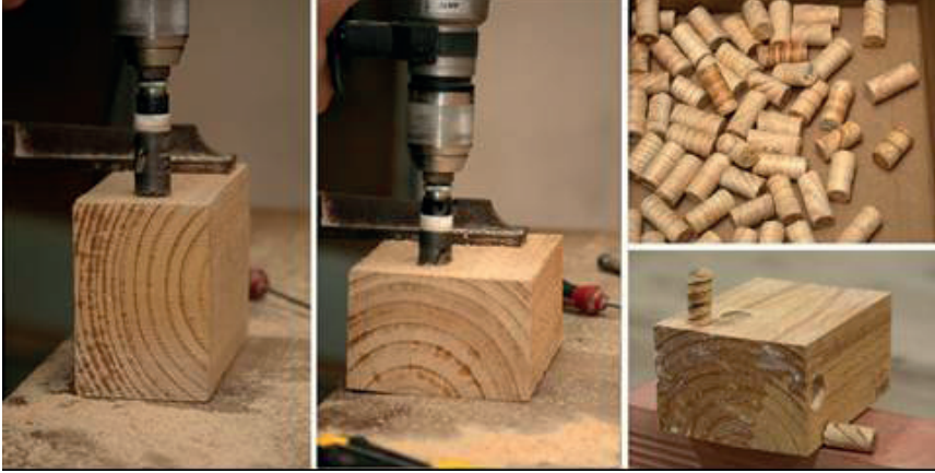
Şekil 6. Karot alma yöntemi (Íñiguez-González vd., 2015)
