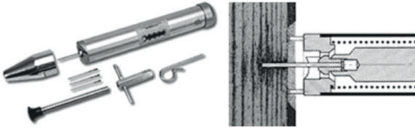
Şekil 5. Pilodyn ve çalışma modu (Zhao vd., 2024)
