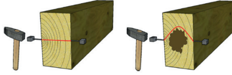
Şekil 1. Sağlam (solda) - çürümüş (sağda) kerestede gerilim dalgası yayılımı (Dackermann vd., 2014)
