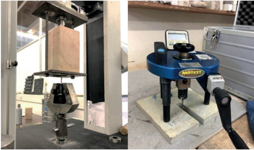
Şekil 11. Vida tutma direnci deney düzeneği (Lima, Branco, Parracha ve Nunes, 2022).
