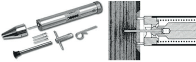
Şekil 5. Pilodyn ve çalışma modu (Zhao vd., 2024)
