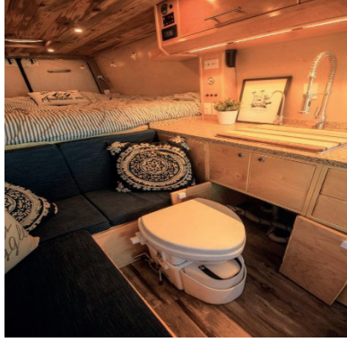
Şekil 10. Mutfak Lavabosunun Altında Kullanılan Tuvalet Kaynak: (Karavan Yap, 2022)
