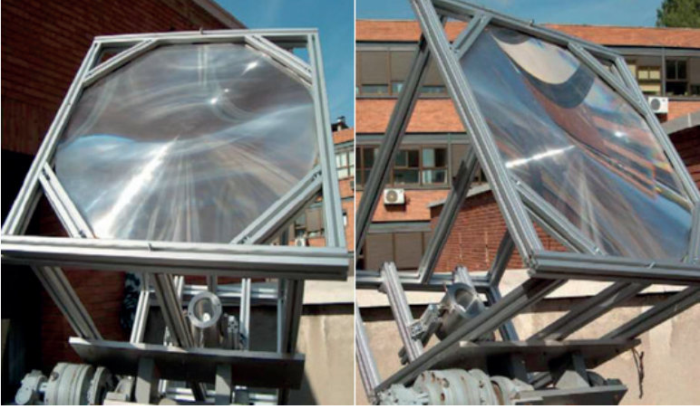
Resim 4. Fresnel Lenslerinin montaj şekli (Xie ve Ark, 2011)
