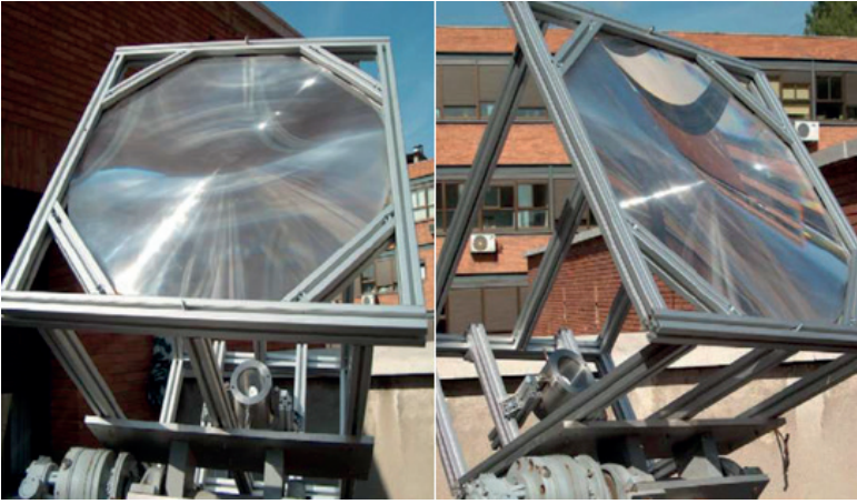
Resim 4. Fresnel Lenslerinin montaj şekli (Xie ve Ark, 2011)
