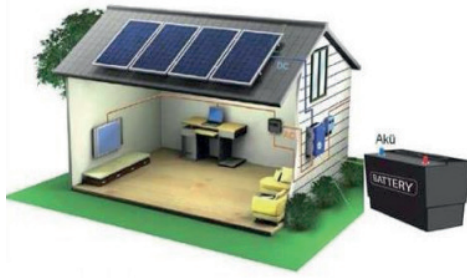
Şekil 6. Fotovoltaik panel çalışma prensibi örnekleme görselleştirmesi.
