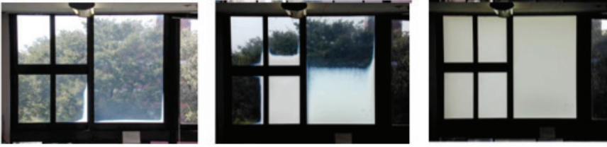
Resim 9: Termo-kromik camın farklı durumlarda görünümü(kaynak: Inoue, Ichinose, Ichikawa, 2008)
