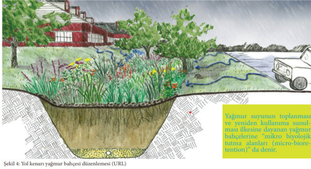
Resim 8: Yağmur bahçesi düzenlemesi (url 20)
