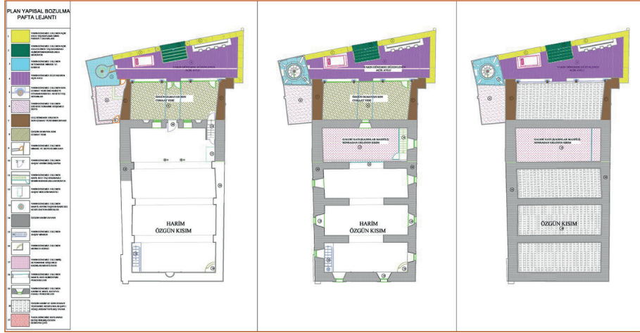
Şekil 11. Deliklitaş Mescidi yapısal bozulma paftası renklendirilmiş plan çizimi
