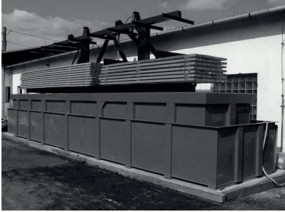
Şekil 3. Daldırma yöntemine hazır ahşap malzeme ( Impregnation Methods, 2024'den işlenerek ).
