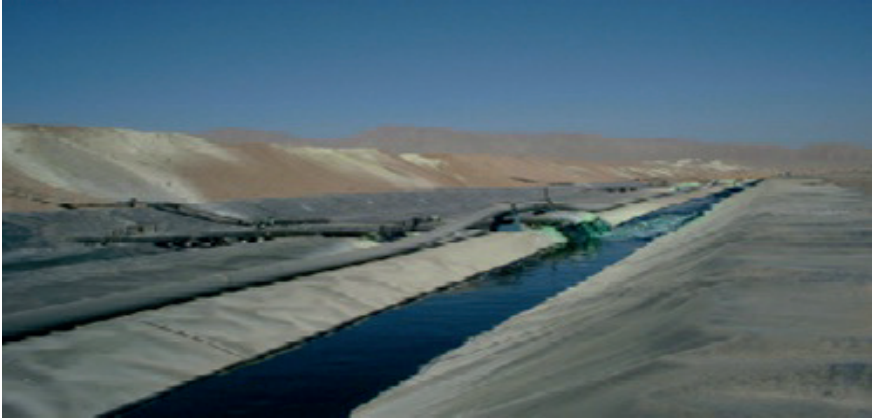
Şekil 11. Bakır Yığın Biyoliçi (Gahan ve ark. 2012).
