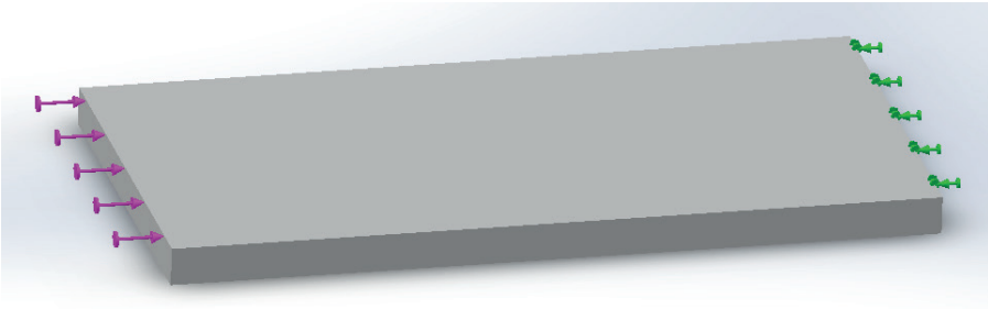
Şekil 4. Sınır koşulları uygulanan kompozit plaka modeli
