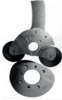
Şekil 4. Çift kam profilli eşlenik pozitif bir ağızlık açma kamı
