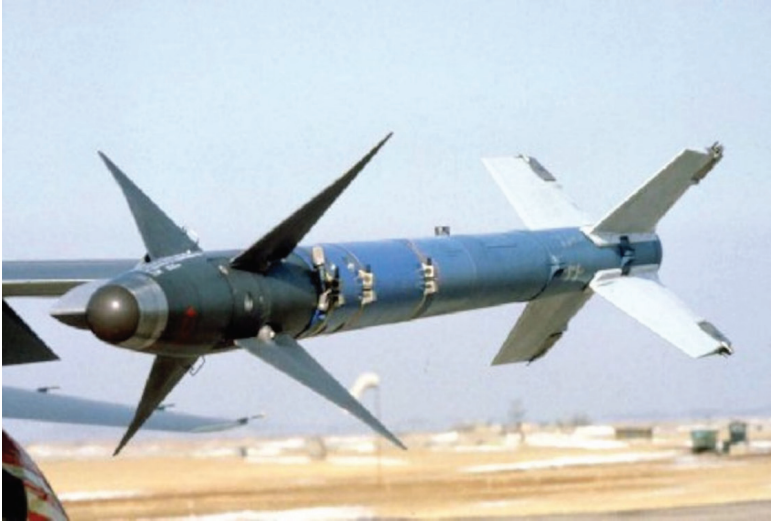
Şekil 7. Burundan Denetim Kanatçıklı AIM-9L Sidewinder Füzesi (ABD Hava Kuvvetleri İnternet Sayfası-AIM-9L Sidewinder, 2022)
