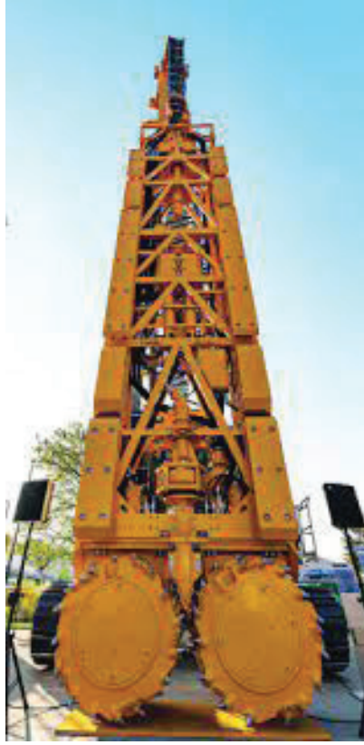
Şekil 13. Muratlı barajında plastik beton duvar kazısında kullanılan Bauer freze (trench cutter) makinesi (URL-5)
