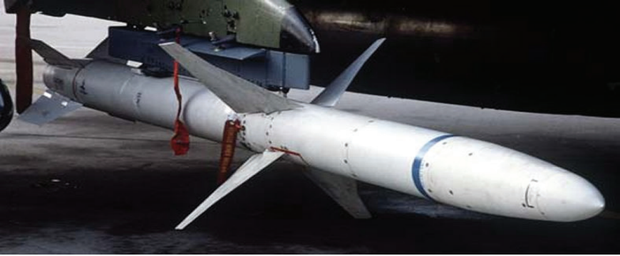
Şekil 9. Orta Gövdeden Denetim Kanatçıklı AGM-88 HARM (FAS Military Analysis Network, 2022)
