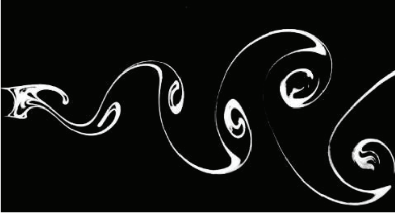
Şekil 1.1. Re=140 'ta bir silindirin arkasında bir Kármán girdap caddesi, Van Dyke'den S. Taneda'nın fotoğrafı (Van Dyke, 1988)
