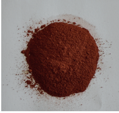
Şekil 1. Ni-Co Kompozit Katı Atığı Görseli
