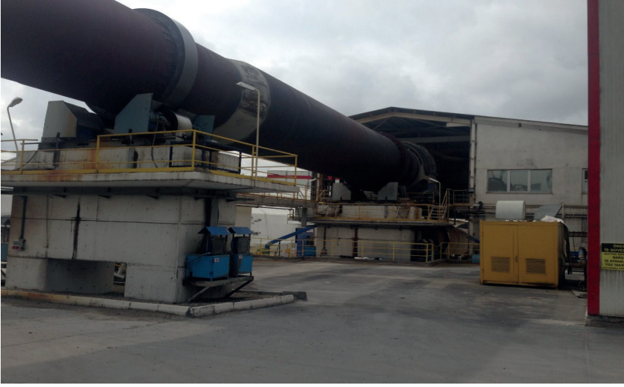
Şekil 4. Döner Fırın Ağzı (Ateşleme Merkezi)
