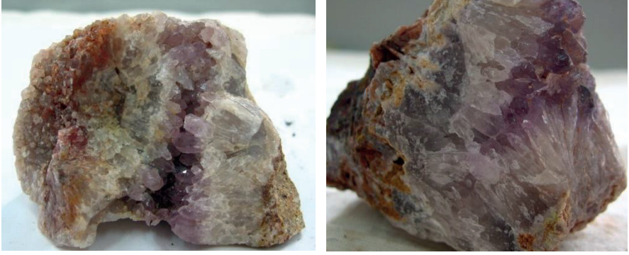
Şekil 9. Simetrik kuvars büyümeleri - tarak dokusu
