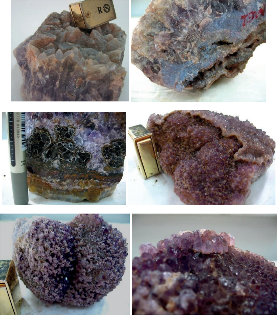
Şekil 21. Mikro ve iri kristal kuvarşın bir arada bulunduran üst üste büyümeler.
