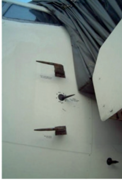
Şekil 1. Ticari bir uçakta yer alan hava sensörleri (yukarıdan aşağıya doğru) kaptan pitot tüpü, hücum açısı, II. pilot pitot tüpü, toplam hava sıcaklığı sensörü)
