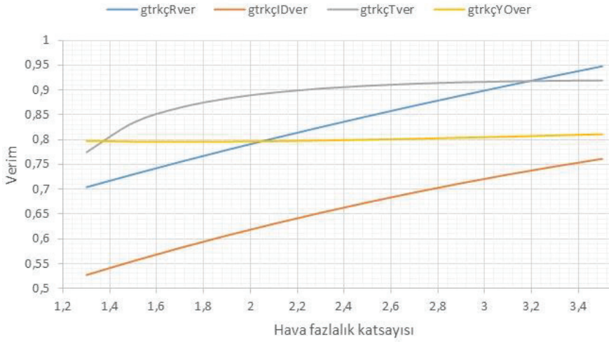
Şekil 8: Hava fazlalık katsayısının türbin, yanma odası, kompresör ve ısı değiştiricisi (HRSG) cihazlarının verimleri üzerine olan etkisinin değişimi.
