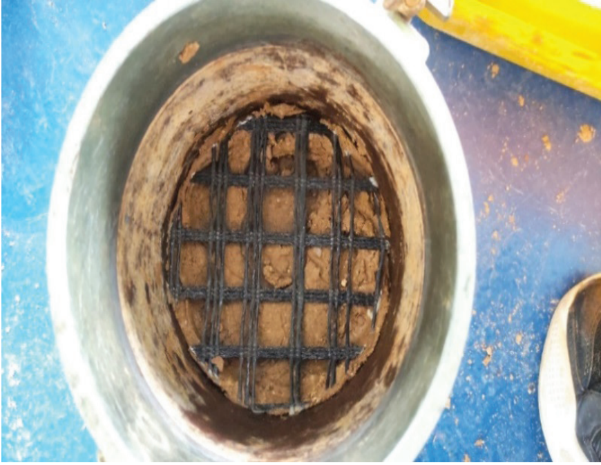
Şekil 4. CBR kalıbına yerleştirilen geogrid
