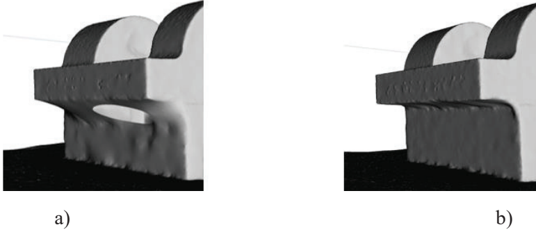
Şekil 6. Bir makine parçasından 3B fotogrametri yöntemiyle üretilen 3 boyutlu modeller. a) Tek dikey çekim açısı (35 derece) kullanılarak çekilen 24 fotoğraftan elde edilen 3 boyutlu model, b) İki farklı dikey çekim açısı (0 ve 45 derece) kullanılarak çekilen 48 fotoğraftan elde edilen 3 boyutlu model.
