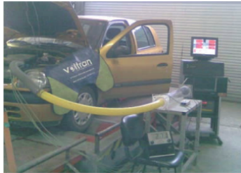
Şekil 8: Taşıt dinamometresi üzerinde güç ölçümü (Gümüş, 2013)
