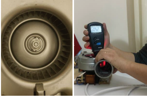
Şekil 7. Radyal Fan Çarkı ve Takografla Çark Devir Ölçümü
