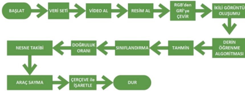
Şekil 3. Araç Sayma Üzerine Görüntü İşleme İşlem Adımları
