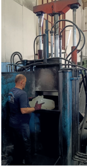
Şekil 5. Kapalı karıştırıcıya kauçuk ilavesi
