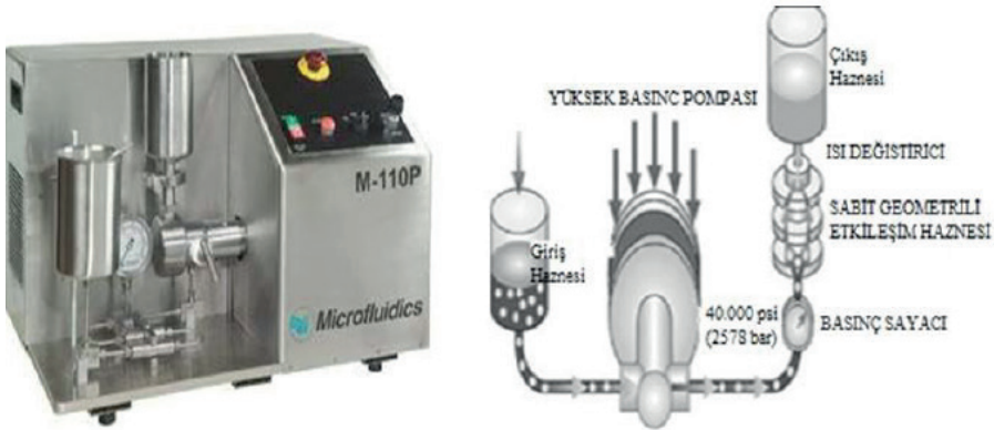
Şekil 4.2. Mikrosivılaştırıcı cihazının dış ve iç görünüşü (Kurtuluş, 2019)
