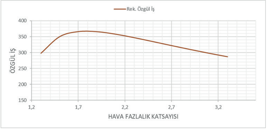
Şekil 8. Reküperatörlü kojenerasyon tesisinde özgül işin hfk-hava fazlalık katsayısı ile değişimi.
