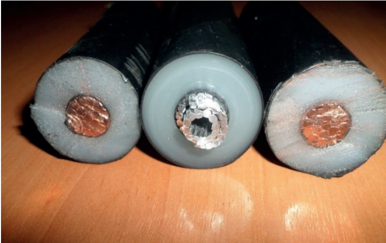
Şekil 2. Bakır ve alüminyum iletkenli XLPE izoleli tek damarlı orta gerilim kabloları (Karhan, 2017)
