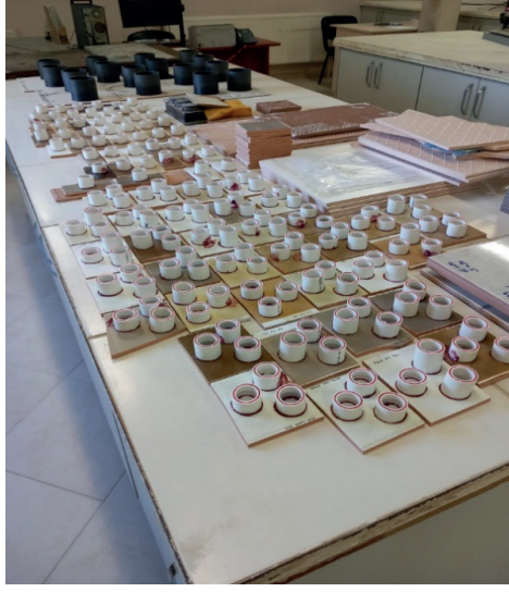
Şekil 3. Laboratuvarda Uygulanan Kimyasal Maddelere Dayanım Testleri
