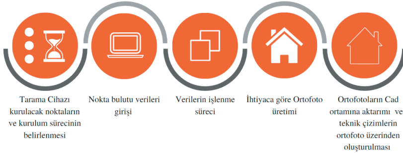
Şekil 1. Yersel lazer tarama teknolojisi ile belgeleme süreci
