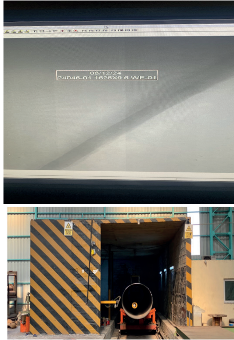
Şekil 5. Radyografik muayenin gerçekleştirilmesi(Aydın, N., 2024)
