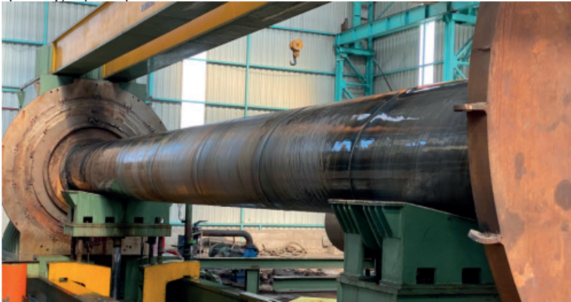
Şekil 4. Hidrostatik test işleminin gerçekleşmesi(Aydın, N., 2024)
