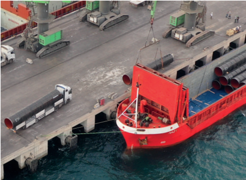
Şekil 10. Deniz yolu ile sevkiyatı yapılan dış polietilen içi solventsiz epoksi kaplı spiral kaynaklı çelik borular(Aydın, N., 2024)
