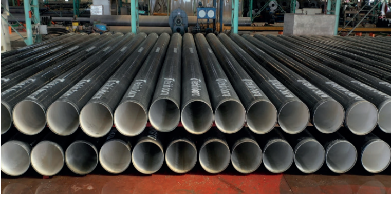
Şekil 9. Dış polietilen içi beton kaplı çelik borular(Aydın, N., 2024)
