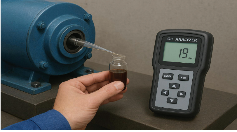
Resim 8. Bir motorun yatağından alınan yağ ile içerisindeki partikül analizi
