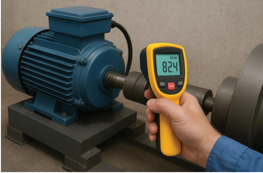
Resim 7. Bir motor çalışırken yatağından sıcaklık ölçümü
