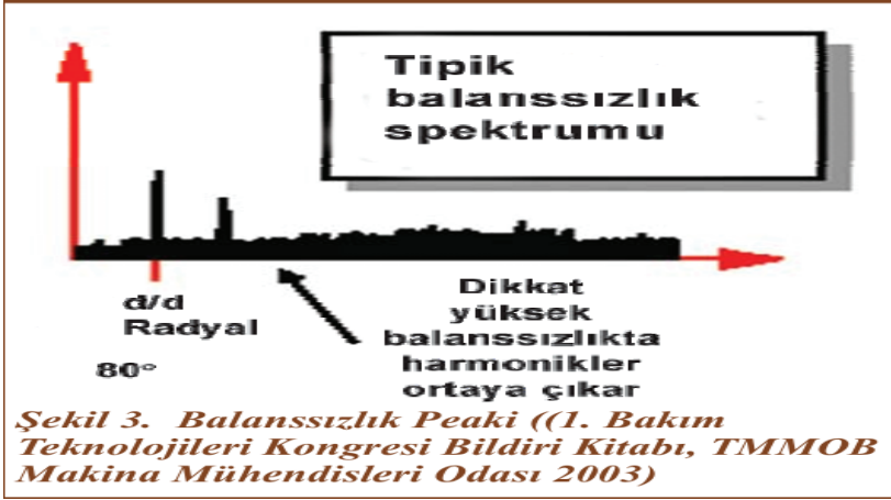
Resim 2. Balanssızlığın frekans grafiğinde gözükmesi
