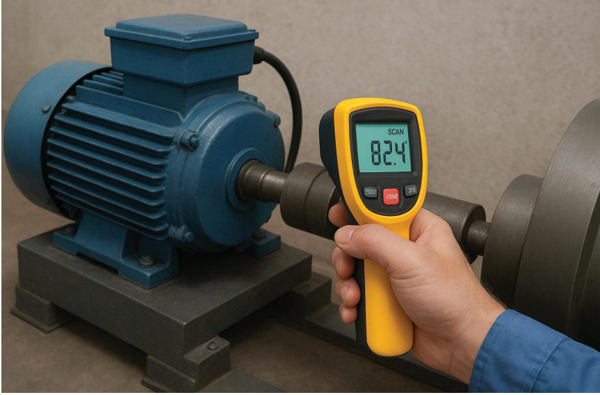
Resim 7. Bir motor çalışırken yatağından sıcaklık ölçümü
