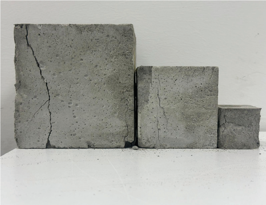
Şekil 5. Basınç testine maruz bırakılmış çimento esaslı harç numuneleri
