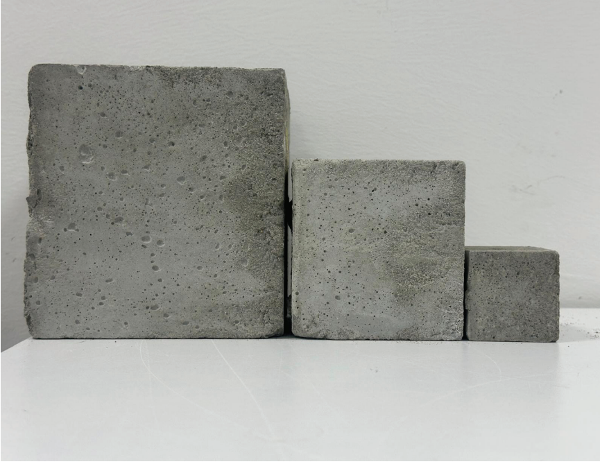
Şekil 4. Basınç testine maruz bırakılmamış çimento esaslı harç numuneleri
