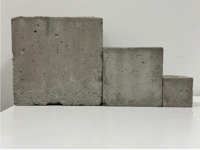
Şekil 8. Yüksek sıcaklığa maruz kalan örnekler
