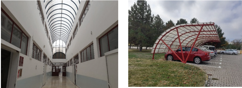
Şekil 10. Çatı sistemlerinde eğri eksenli çubuklar
