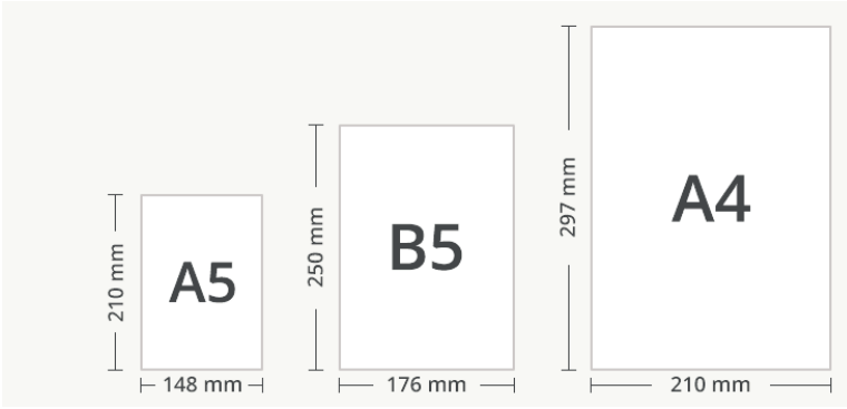
Şekil 8. B Kağıt Standardının A Serisinden Farkı
