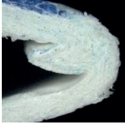
Şekil 1. Kağıt Kesiti (Sappi, 2003)
