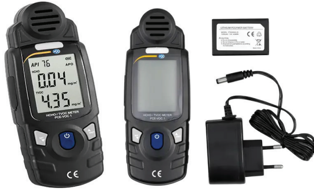
Görsel 1: Formaldehit ( \text{CH}_2\text{O} ) ve uçucu organik bileşik gaz ölçüm cihazı.
