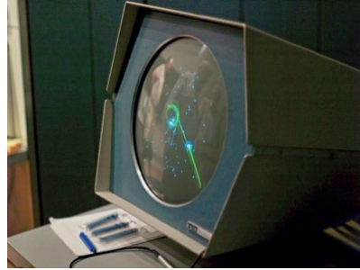
Resim 3. "Tennis for Two" oyununun osiloskop cihaz ekranı üzerindeki görüntüsü, 1958.
