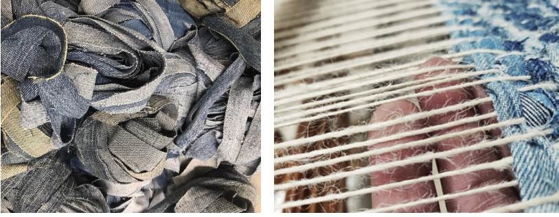
Şekil 7: Şeritler halinde kesilmiş denim ve dokuma aşaması ( https://www.reetaus.com/blogs/news/local-upcycling-carpets-made-from-post-consumer-denim , erişim tarihi: 30.01.2023).
