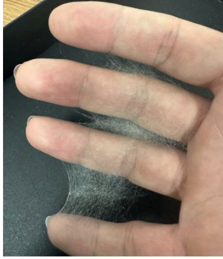
Şekil 8. Oje püskürtme makinası ile insan eline uygulanan saf PLA nanolif fotoğrafı
