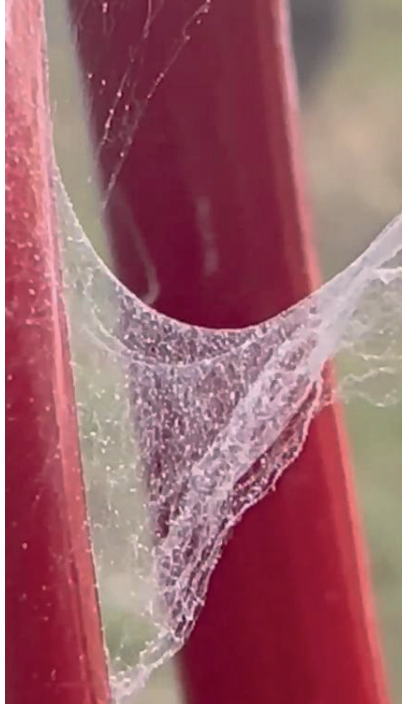
Şekil 6. Dövme makinesi ile plastik yüzeye püskürtülen PLA nanolif fotoğrafı
