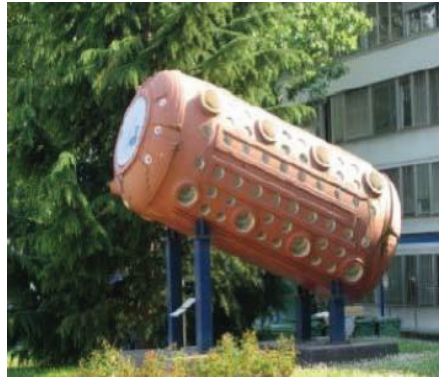
Resim 6. CERN Gargamelle (BEBC) Köpük Algıcı (Görsel: CERN).
