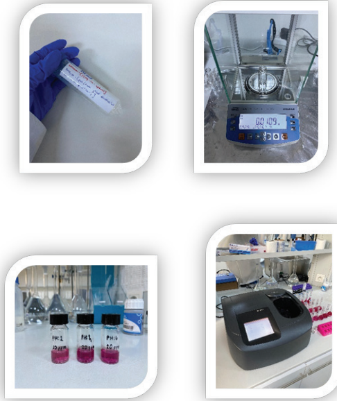
Şekil 7. 300 \mu\text{m} -[p(eg-co-vpdon)] polimerinin farklı pH'lardaki UV- VIS absorpsiyonu
