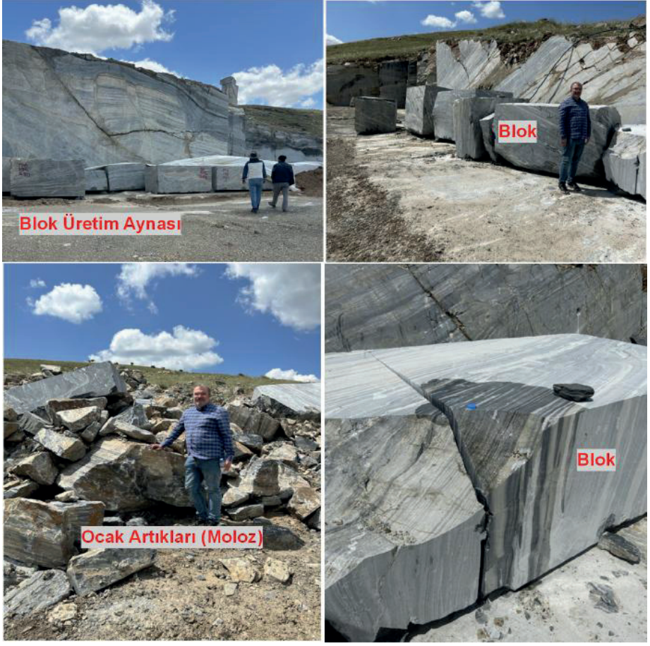
Şekil 3. Karıncalı bölgesi EBA Madencilik'e ait mermer ocağının genel görünümü, artıklar (moloz) ve kalkıştelerin renk ve dokularını gösteren bloklar
