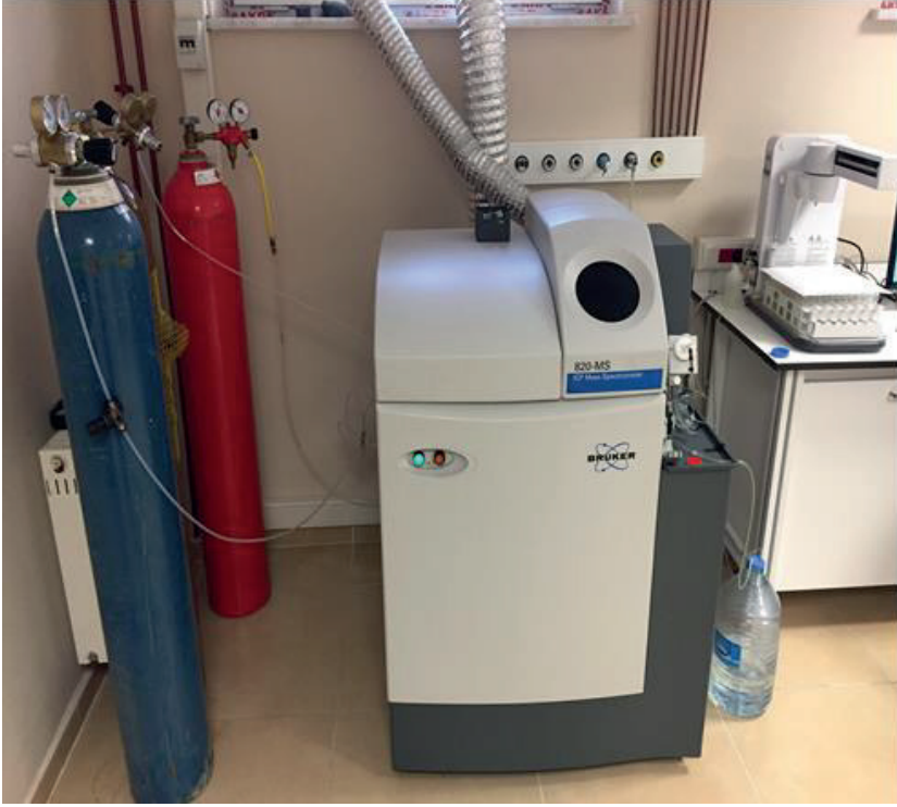
Şekil 2. ICP-MS Mass Spectrometer 820 analiz cihazı
