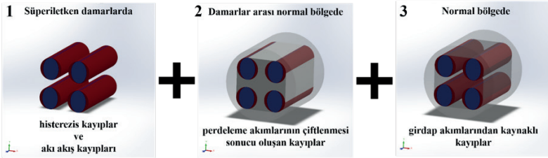
Şekil 2. Kompozit bir süperiletkende meydana gelen toplam AC kaybı
