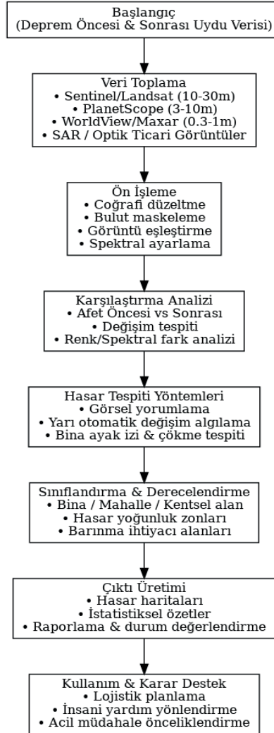
Şekil 4:Kapsamlı uydu tabanlı hasar değerlendirme (UNITAR-UNOSAT) akış şeması
