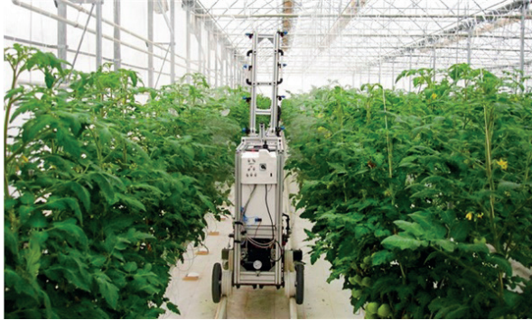
Şekil 3. Örtü altı kumandalı otomatik ilaçlama sistemli insansız kara aracı.
