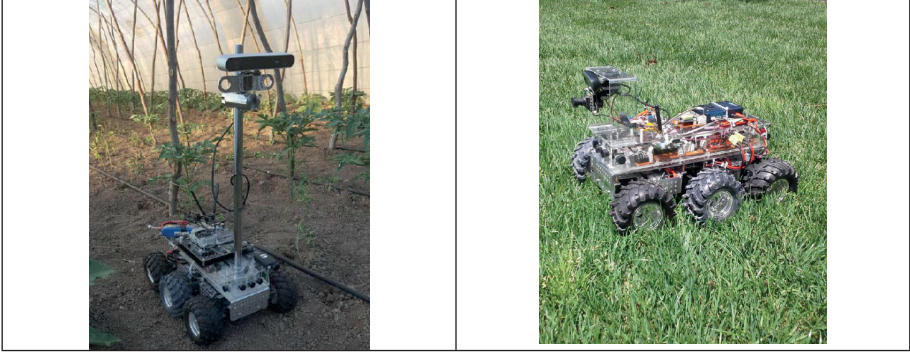
Şekil 2. a) Otonom veri toplayan insansız kara aracı. b) Derin öğrenme destekli insansız kara aracı.
