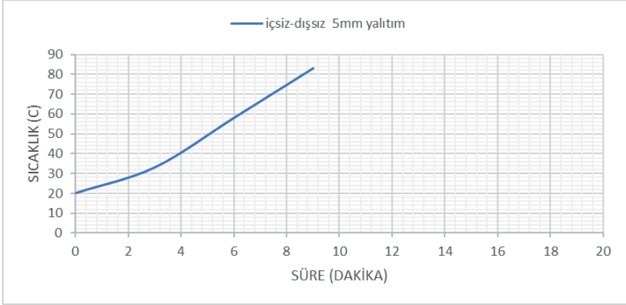
Şekil 11. Çelik tencere etrafının sac yuvarlak levha kullanmadan 5 mm yalıtım ile kapatılmasında sıcaklık süre değişimi.
