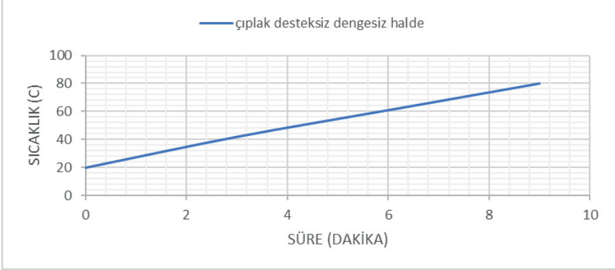
Şekil 35. Çelik tencerenin gazlı ocakta minimum sürede sıcaklığını 20^{\circ}\text{C} 'den 80^{\circ}\text{C} 'ye çıkarmak için çıplak desteksiz dengesiz hal için sıcaklık süre değişimi.
