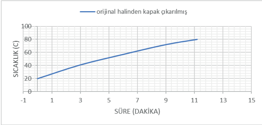
Şekil 37. Çelik tencerenin orijinal gazlı ocaktan kapaksız durumda sıcaklığını 20 °C'den 80 °C'ye çıkarmak için sıcaklık süre değişimi.
