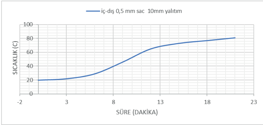
Şekil 6. Çelik tencere etrafının 10 mm yalıtımın iç ve dışının 0,5 mm sac yuvarlak levha ile kapatılmasında sıcaklık süre değişimi.
