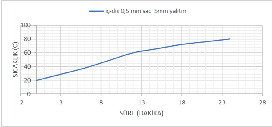
Şekil 5. Çelik tencere etrafının 5mm yalıtımın iç ve dışının 0,5 mm sac yuvarlak levha ile kapatılmasında sıcaklık süre değişimi.
