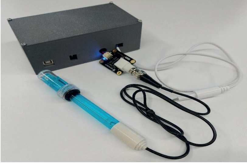
Şekil 4: Sistemin elektronik son tasarım kasası ve çıkış bağlantı yolları
